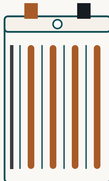
2 V · tubular gel · VRLA
